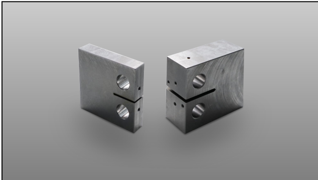
Links: CT Prüfling mit W/B=4 . Gebräuchliche Geometrie für ASTM E647, rechts: CT Prüfling mit W/B=2 . Gebräuchliche Geometrie für ASTM E399
