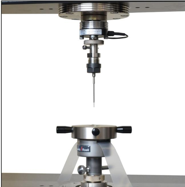
Prüfvorrichtung zur Bestimmung der Durchstoßfestigkeit
