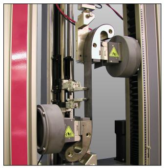
Umlenk-Probenhalter Typ 8314, Fmax 10 kN
