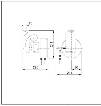
Umlenk-Probenhalter Typ 8314 Fmax 10 kN, Übersicht
