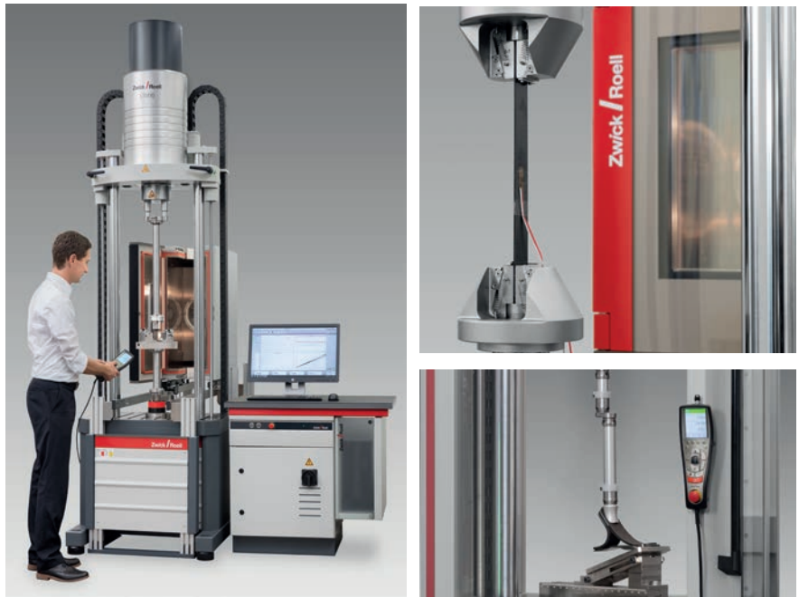
Bild 1: LTM 10 – Ermüdungsprüfung in verschiedenen Prüffarten im Lastbereich
