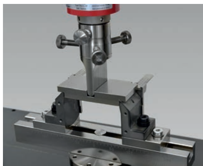
Bild 3: Stempel und Auflager werden mit Einstelllehre unter Last verspannt und ausgerichtet.
