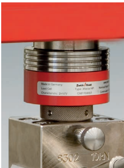
Bild 1: Kraftaufnehmer für höchste Qualitätsanforderungen. Eingebauter Kraftaufnehmer der Xforce HP Baureihe (links). Verschiedene Kraftaufnehmer der Baureihe Xforce HP und P (rechts).
