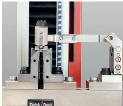
Bild 3: Standard 10 mm Einstelllehre für exakte Ausrichtung
