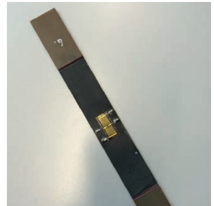
Bild 3: Messung der Schubdehnung mit Dehnungsmessstreifen
