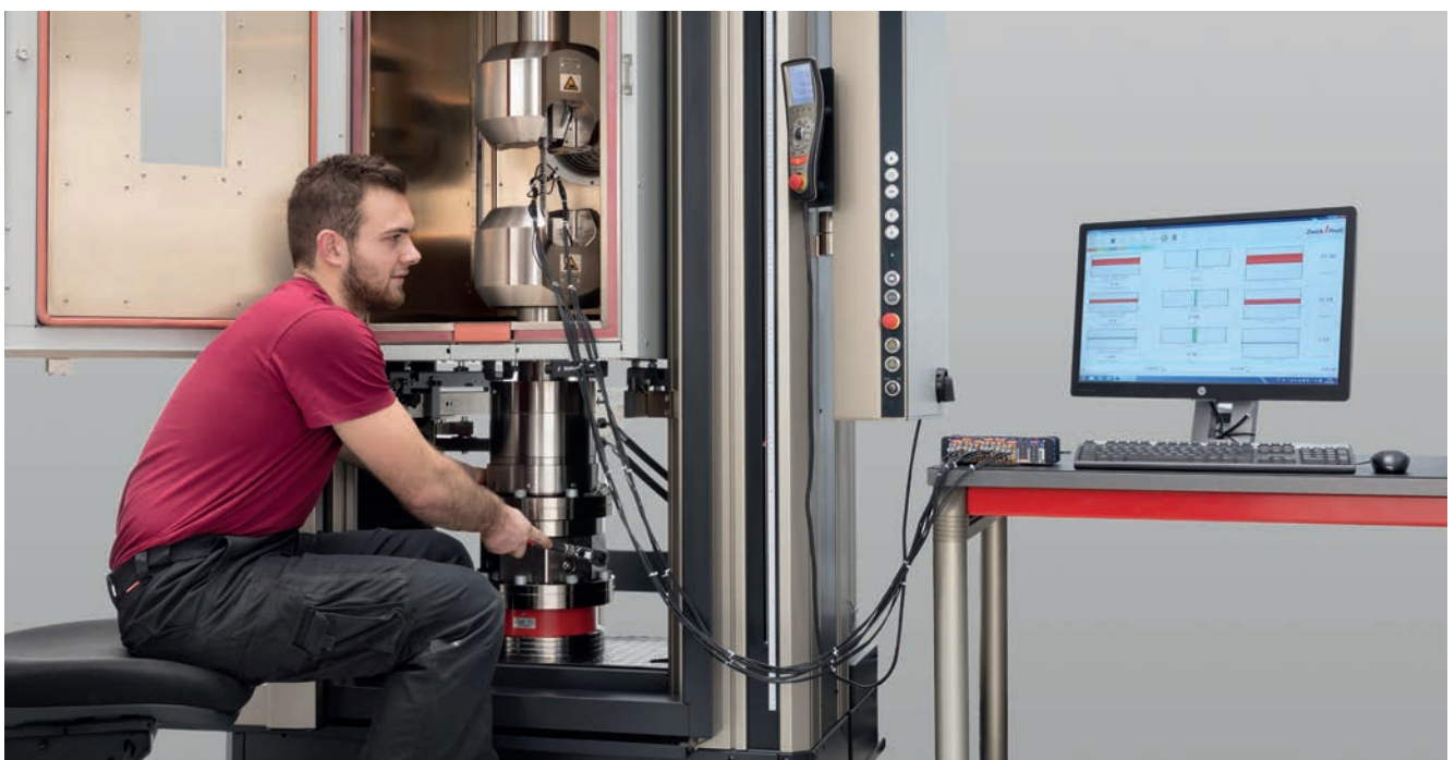
Bild 1: Ausrichtung der Prüfmaschine und Überprüfung des Schiefzugs mit einer Messeinrichtung nach Nadcap AC 7122 durch einen ZwickRoell Techniker.
