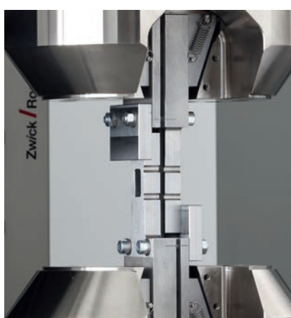
Bild 5: OHC und FHC Druckversuche nach ASTM erfordern eine Knickstütze, die sowohl im shear loading mit hydraulischen Probenhalter, als auch im end-loading zwischen Druckplatten verwendet wird.
