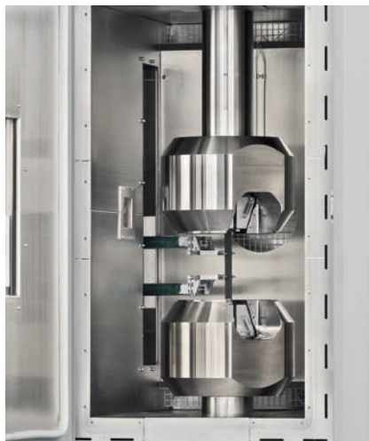
Bild 2: makroXtens mit langen Fühlern für Zugversuche in Temperierkammer
