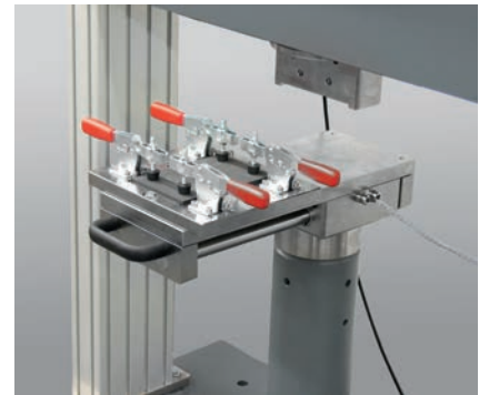
Bild 3: Sichere Aufnahme des CAI Probekörpers im Fallwerk
