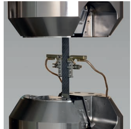
Bild 5: Axial messender Ansatz-Wegaufnehmer
