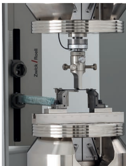
Bild 3: makroXtens mit Biegeföhler für 3- und 4-Punkt Biegeversuche
