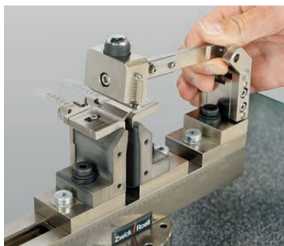
Bild 4: Einstelllehre mit variablem Auflagerabstand
