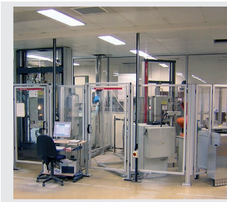
Bild 1: Vollautomatische Prüfanlage mit zwei Lastrahmen für Zug, OHT, FHT, IPS, Scherung durch Überlappung, ILSS, Lochleibungs- und Biegeprüfungen in einem breiten Temperaturbereich.
