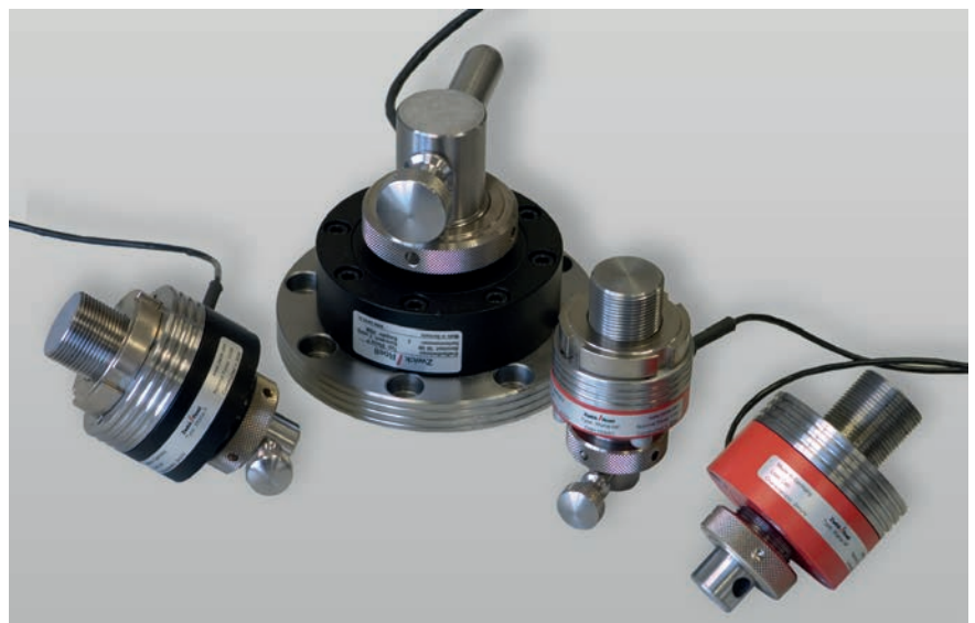
Bild 1: Kraftaufnehmer für höchste Qualitätsanforderungen. Eingebauter Kraftaufnehmer der Xforce HP Baureihe (links). Verschiedene Kraftaufnehmer der Baureihe Xforce HP und P (rechts).
